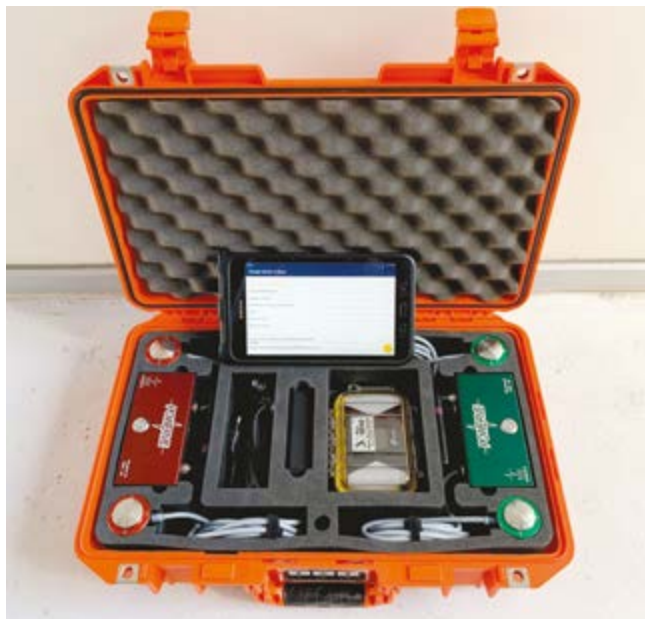
Il sistema POWERVE per la misurazione in loco dell'equilibrio dei rotabili ferroviari
